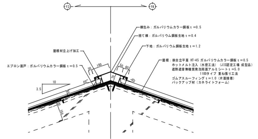
改修後 A-A 断面詳細図 S=1/10
