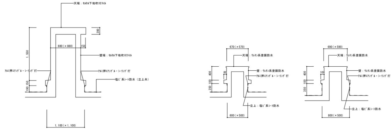
換気塔外塔断面図 (改修前) S=1/30
