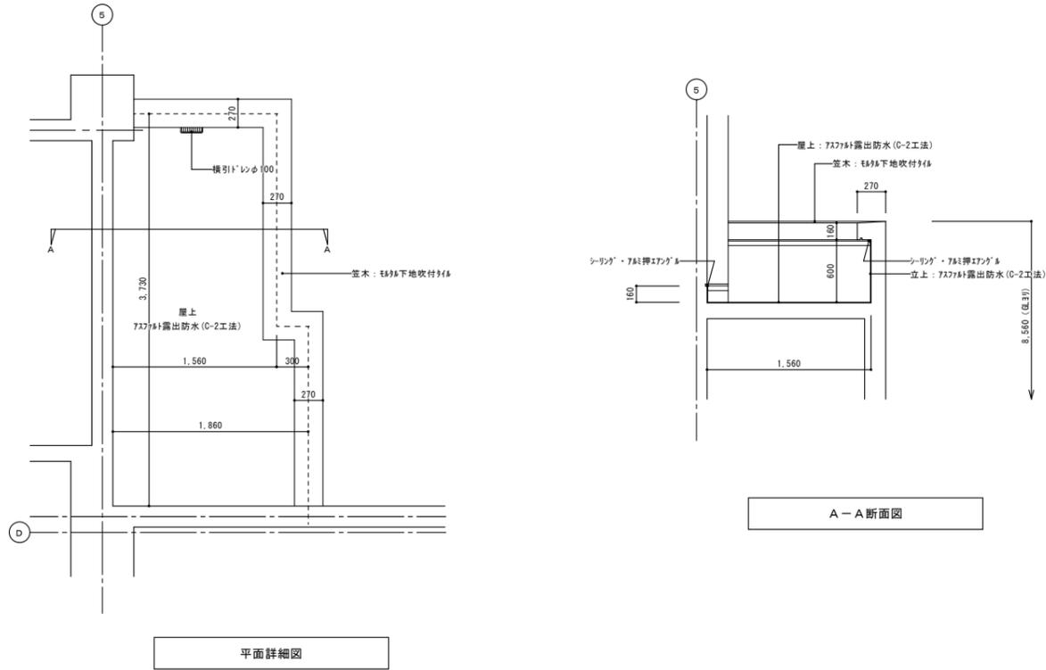
2階便所屋上平面図・断面図 (改修前) S=1/30
