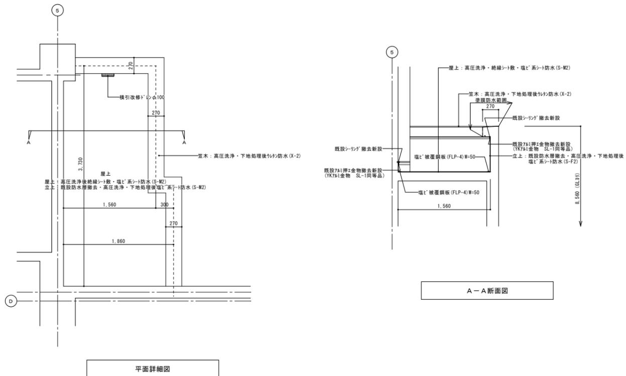
2階便所屋上平面図・断面図 (改修後) S=1/30
