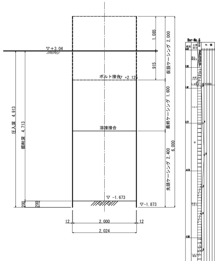
底盤コンクリート打設・引抜き完了図
