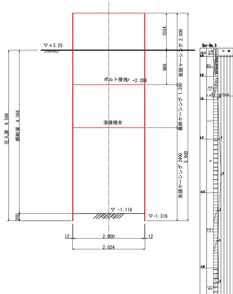
底盤コンクリート打設・引抜き完了図
