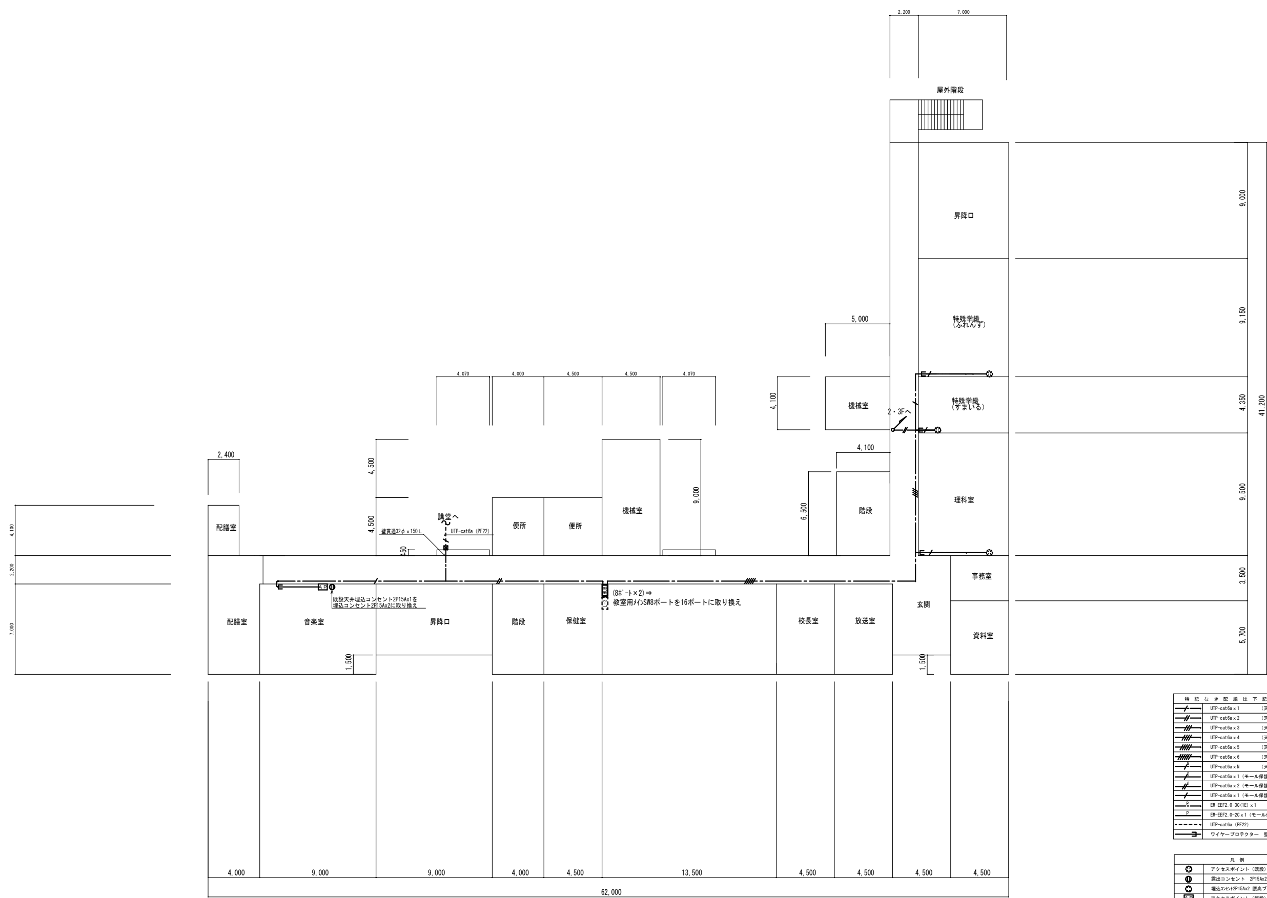
校舎LAN設備 1階配線図 S=1/150
