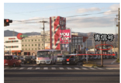
▲同じ方向の信号機が異なる動きをすることによって、後続車が青信号で進めず、先詰まりを起こしています。
