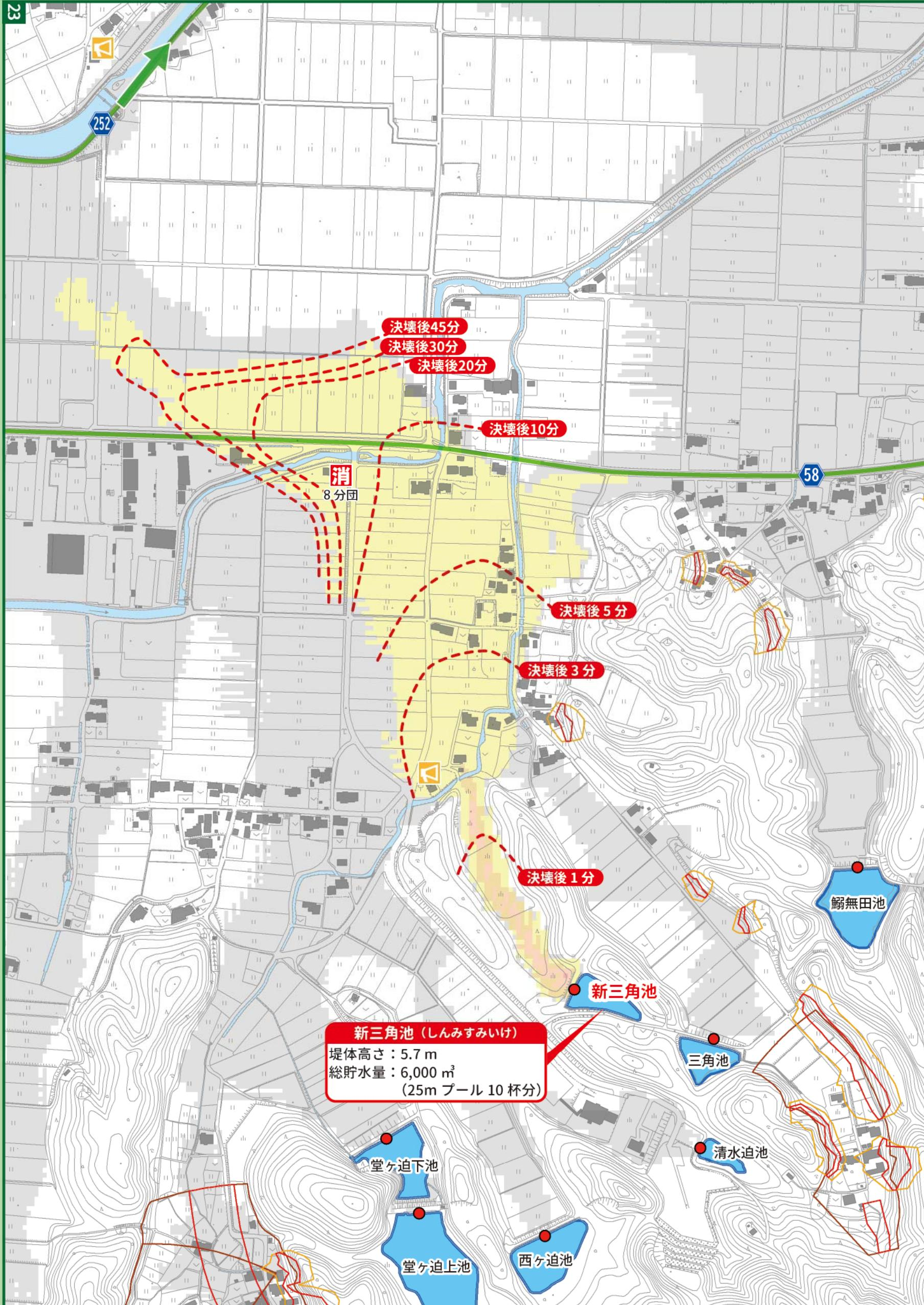
このマップは、農業用ため池の貯水量が満水の状態で堤体が決壊した場合のシミュレーション結果を用いて、おおよその浸水範囲や浸水深を示しています。
