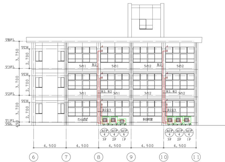
改修後：南棟系統図 <南面>
