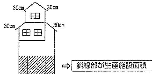
例3. 同一工場内に製造装置と倉庫、出荷場があり壁で明確に区分されていない場合
